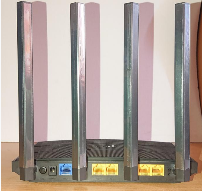
Arrière d'un routeur : prise Internet (WAN) en bleu, prises numérotées en jaune
